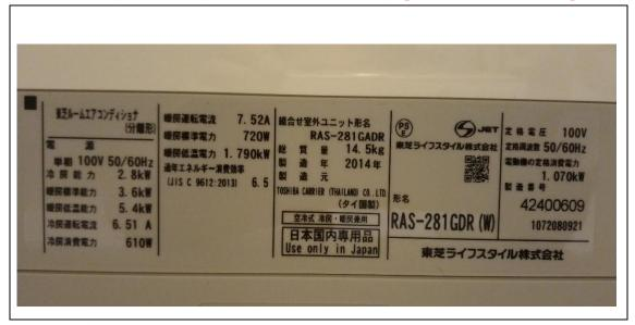
電気冷蔵庫:定格内容積 (L) エアコン:冷房能力 (2.8 kW) 照明器具:消費電力 (W)
