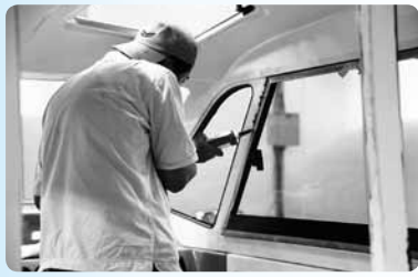
▲強化ガラスをボンドで固定している様子
