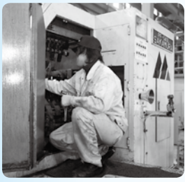
▲鍛造機の調整作業の様子
