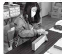
▲レーザー加工で出たススを拭く作業
