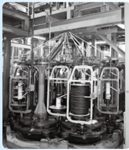
▲大型ロープを編む機械
