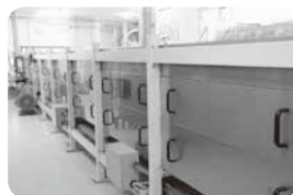
▲遠赤外線により焼成する機械
