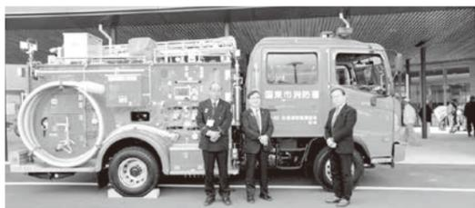
一般財団法人空港環境整備協会の助成を受け、11月9日(水)国東市消防署南分署に新しく最新鋭の化学消防車が配備されました。化学車は圧縮空気泡消火システム(CAFS)を装備し、消火薬剤と水とを圧縮空気で作成させた泡消火が行えるようになっています。11月9日(水)市役所応接室で行われた贈呈式には、同協会の南 朋幸 大分事務所長より、三河市長へ助成目録が手渡されました。尚、管内の消防自動車の配備状況は、姫島出張所に1台、国見出張所に1台、南分署に4台(化学車・救助工作車含)、本署に3台となっています。
