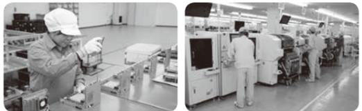
▲受注仕様に応じた組立工程 ▲自動部品搭載ライン
