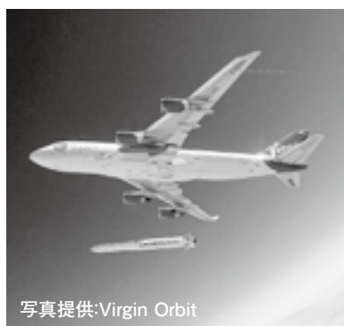
写真提供: Virgin Orbit 航空機から空中発射するロケットで、人工衛星を宇宙に打ち上げます。
