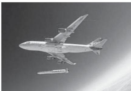
航空機から人工衛星を打ち上げる
